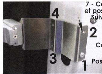
6 Contre Percer Ø 5mm et Poser le 1er Rivet
