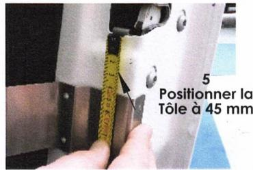
5 Positionner la Tôle à 45 mm
