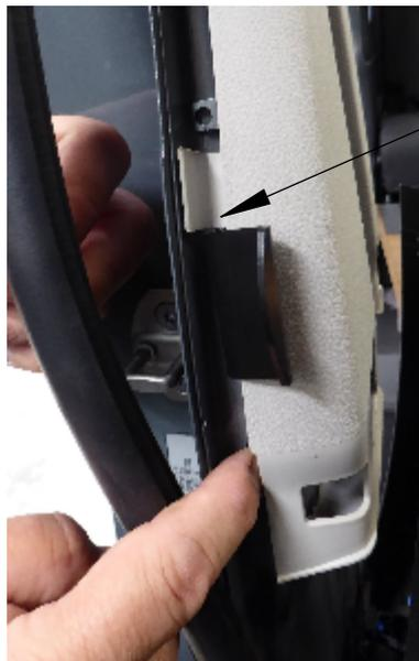
4 - Retirez le Joint Ecarter légèrement la Garniture Positionner la Tôle d'Arrêt en Contact avec la patte Plastique
