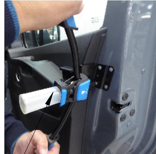
3 - Toujours Bien en Appuis sur la Garniture Contre-Percer et Poser les Rivets suivants
