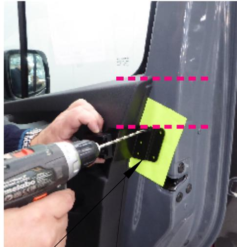
2 - Bien en Appuis sur la Garniture Percer 1 Trou Ø 5 - Retirer le Post-it - Poser un 1er Rivet
